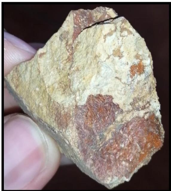
Figura 13. Debido al alto nivel de alteración hidrotermal de la andesita y que el oro se encuentra diseminado en ella, la roca se tritura hasta que resulte como la arcillas Coordinadas N1518937 - E740434.
