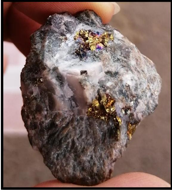
Figura 9. Lava andesítica con impregnaciones de caliza y pirita con un tamaño de 2mm, coordenadas N1519897 - E740232.
