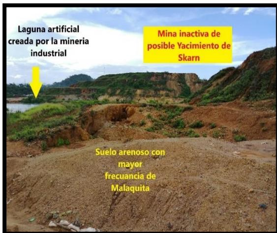
Figura 20. Pertenece al sector minero Santa Rita, extracción de material por mineros artesanales del yacimiento en forma de bolsa que corresponde a un posible skarn, coordenadas N1540013 – E781672.
