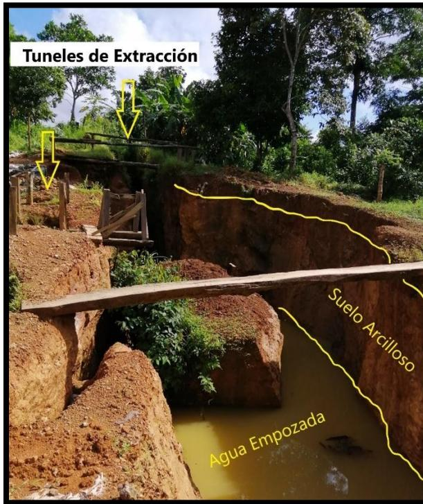
Figura 17. Sector minero Luna Costado sur, presencia de suelos arcillosos, alteración tipo filica (Si).
