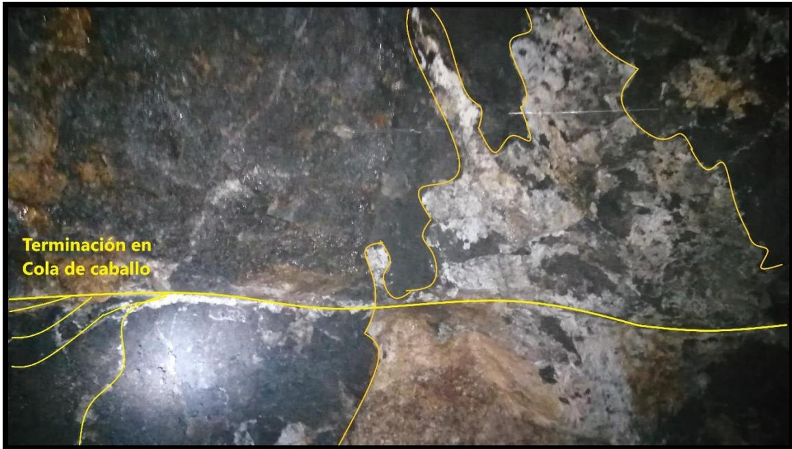
Figura 47. Se puede observar las estructuras R y R' en las fracturas paralelas entre sí, con Rumbo; Norte 30° Este y buzamiento 40°, ubicado en el fondo de unos de los túneles que explotan la veta High land Mery, coordenadas N1550786 - E755599.
