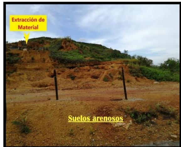
En el sector minero de Santa Rita existe una mayor frecuencia de malaquita que nos indica oxidación de cobre, la mina industrial que existió en esta parte creo una laguna artificial para lavar el material que explotaban de un yacimiento de tipo skarn y en la actualidad el sector es explotado por mineros artesanales que encuentran material con oro en forma de bolsas por lo que se encuentran huecos por todo el lugar.
