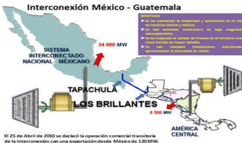
El proyecto consiste en una línea de transmisión 400 KV de 98.6 Km (27 Km en México y 71.6 Km en Guatemala) con un circuito habilitado y las estructuras preparadas para doble circuito, la ampliación subestaciones Los Brillantes y Tapachula, con una capacidad transformación de 225 MW iniciales.
