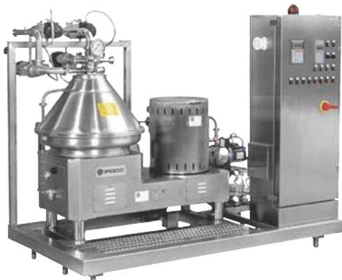
Ilustración 24. Filtro de leche de alta eficacia (uvMilk, 2004)
