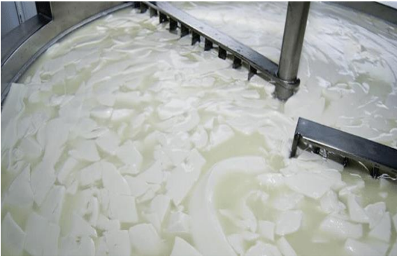
Ilustración 28. Coagulación de leche, corte y desuerado de la cuajada (CONtextogadero, 2021)
