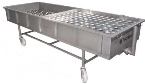
Ilustración 27. Moldeador de cuajada (Technical, s.f.)
