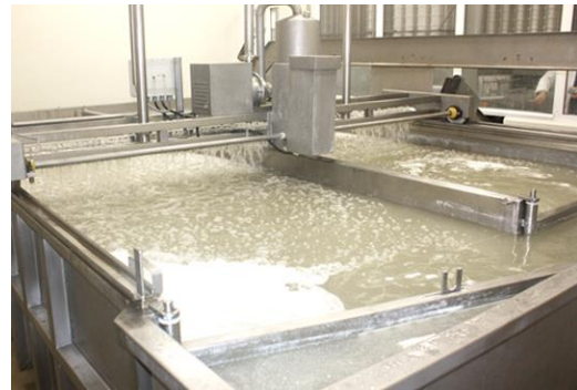
Ilustración 29. Baño de salmuera (Technical, s.f.)
