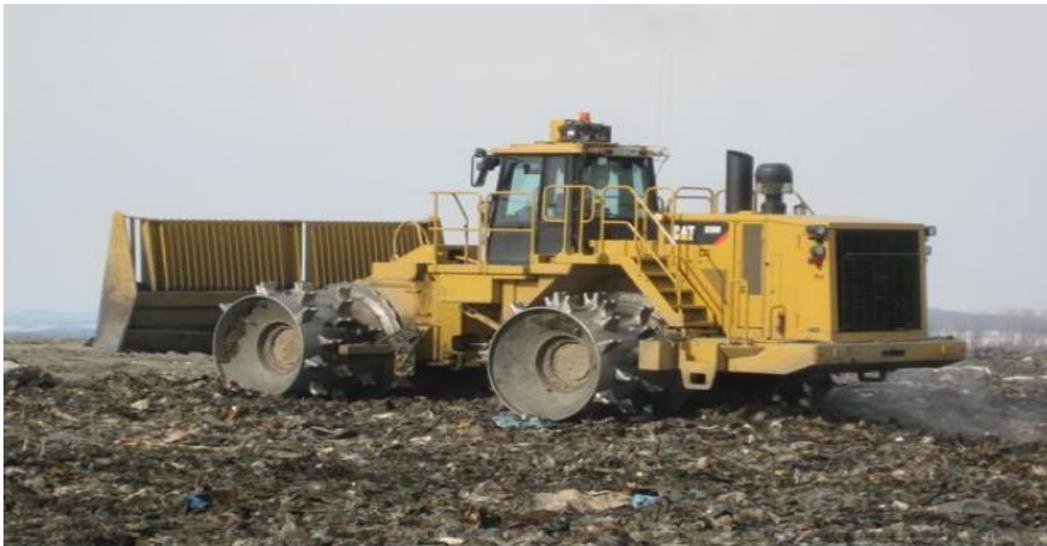
El compactador para relleno sanitario es un compactador con llantas y dientes o pisonos de acero adecuados, para la compactación suficiente de los desechos. El tractor deberá tener la capacidad de esparcir los desechos sólidos y material de cobertura, y realizar mantenimiento de construcción para las vías del relleno sanitario.
