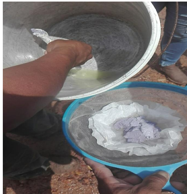
Foto 26: Recuperación de plata con HCl para obtenerla solida
