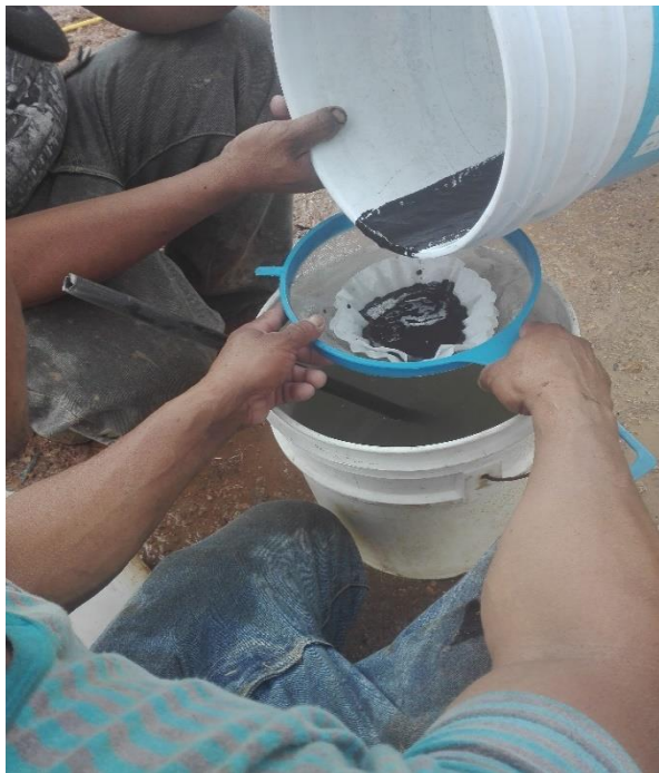
Foto 25: Recuperación de oro por filtración
