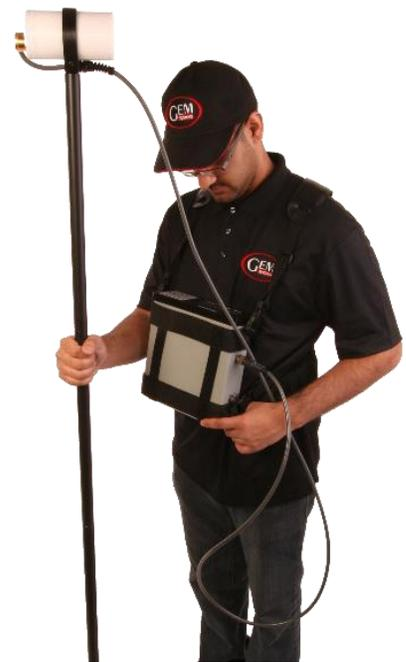
Figura 13. . Instrumentación Magnetométrica. Fuente: info@gemsys.ca
