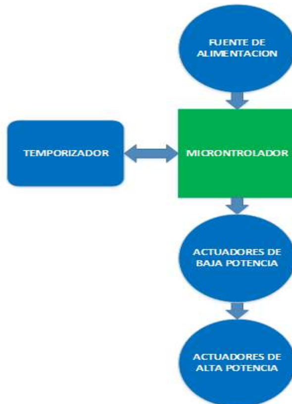
Ilustración 8. esquema básico de componentes del sistema
