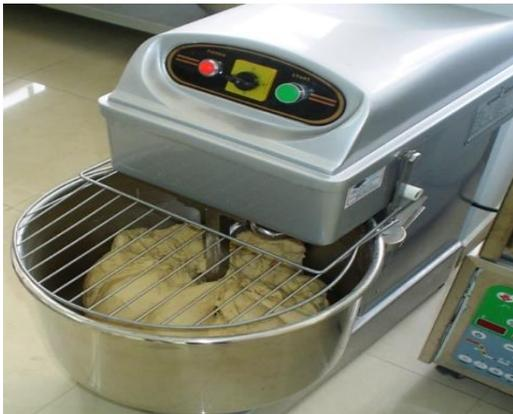
Estos equipos son bastante útiles para mezclar y amasar el pan, para obtener una mezcla uniforme y totalmente elástica. Es muy importante tener presente que se debe amasar con bajas velocidades para no recalentar la masa.
