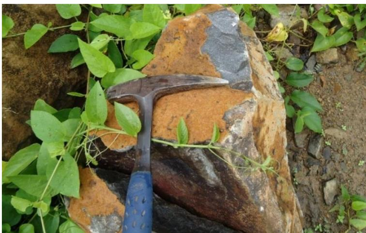
*Fotografía 34. Basalto andesita con fracturas rellenadas de calcita del punto 30062019-27.*
