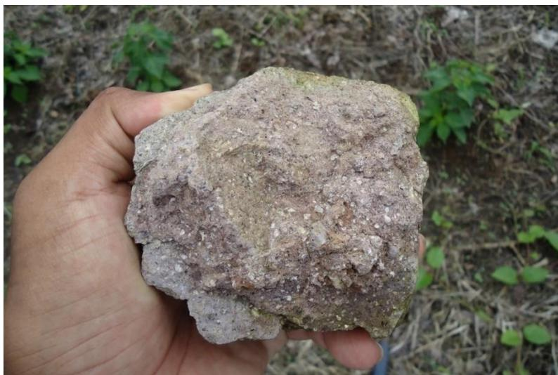
*Fotografía 31. Roca andesita completamente meteorizada.*
