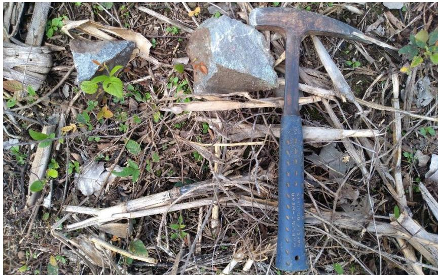
*Fotografía 26. Muestra de andesita gris clara relleno de fractura con calcita (Tmca).*
