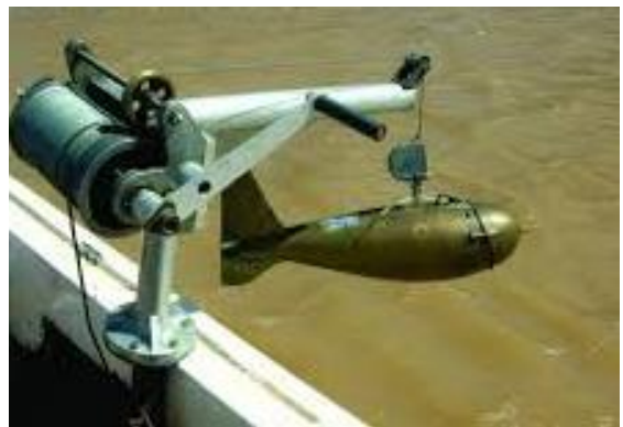
Figura 14. Muestreador integrado de profundidad tipo U.S.D. – 49.
