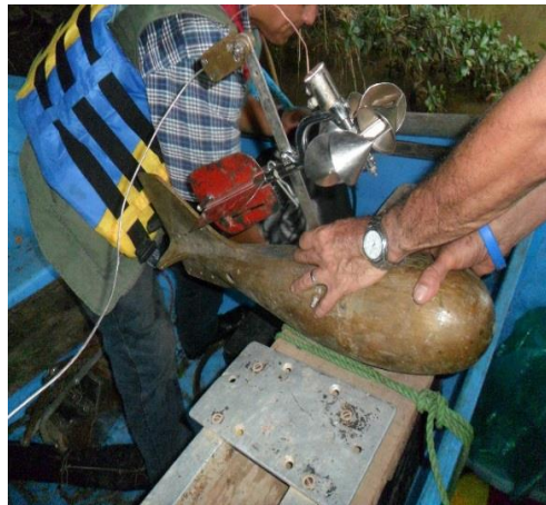
Figura 13. Molinete Gurlly de eje vertical o cazoletas: Tipo Price, de origen norteamericano.
