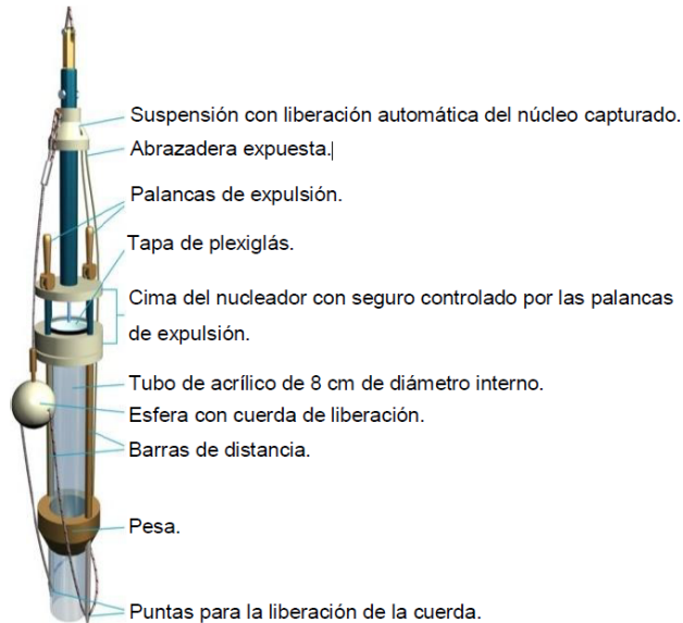
Figura 10. Nucleador de gravedad tipo Uwitec, utilizado para la extracción de perfil de sedimentos
