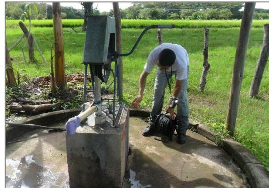
**Figura 16.** Medición de NEA en época lluviosa, PP14, San Nicolás. Coordenadas: N 1418639 - E 550881. Elevación 169 msnm
