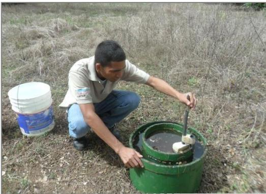
**Figura 18.** Prueba de infiltración PI3 en zona del valle, Esquipulas. Coordenadas: N 1421468 – E 548318. Elevación 156 msnm
