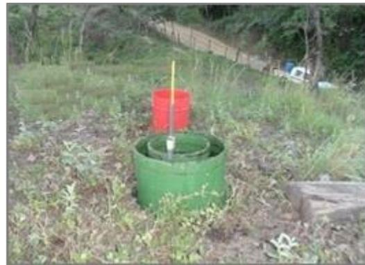
**Figura 19.** Prueba de infiltración PI13 en zona de laderas, El Guayabo. Coordenadas: N 1422533 – E 555941. Elevación 403 msnm
