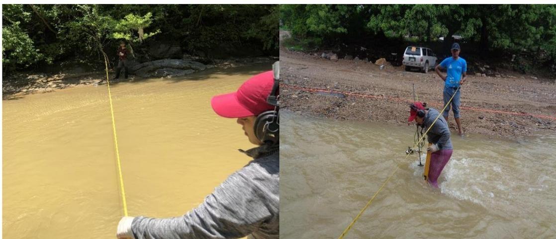
Foto 7. Medición de ancho del río para mediciones de caudal. Sitio 6, río Calderas. 31 mayo 2018.
