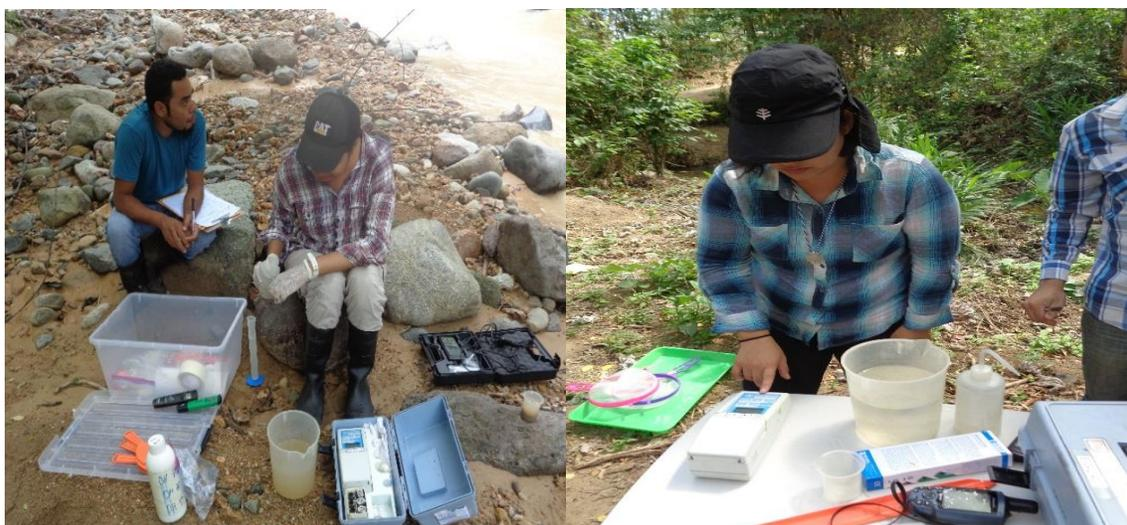
Foto 8. Medición de variables fisicoquímicas en agua superficial. Sitio 6, río Calderas, 31 mayo 2018.
