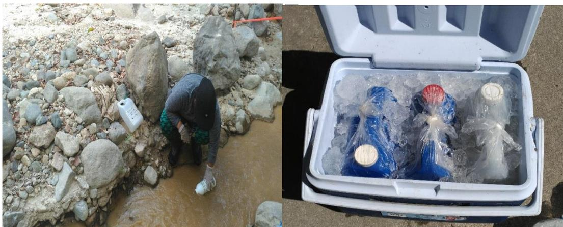
Foto 9. Toma de muestra de agua superficial para análisis de mercurio y preservación en hielo, sitio 6, río Calderas, 17 abril 2018.
