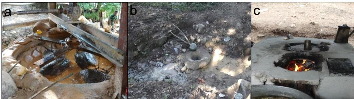
Foto 14. a) Rastra minera artesanal. b) Molinete artesanal. c) Fundición de amalgama en comal. El Corpus, Choluteca 2018.
