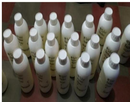
Foto 6. Frascos de plástico listos para ser usados en la colecta de muestras de agua superficial y de lluvia.
