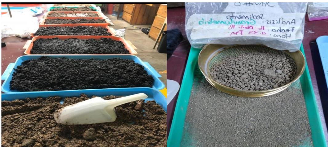
Foto 12. Preparación de la muestra y tamizado para análisis de granulometría. UNI/RUPAP 7 noviembre 2018.
