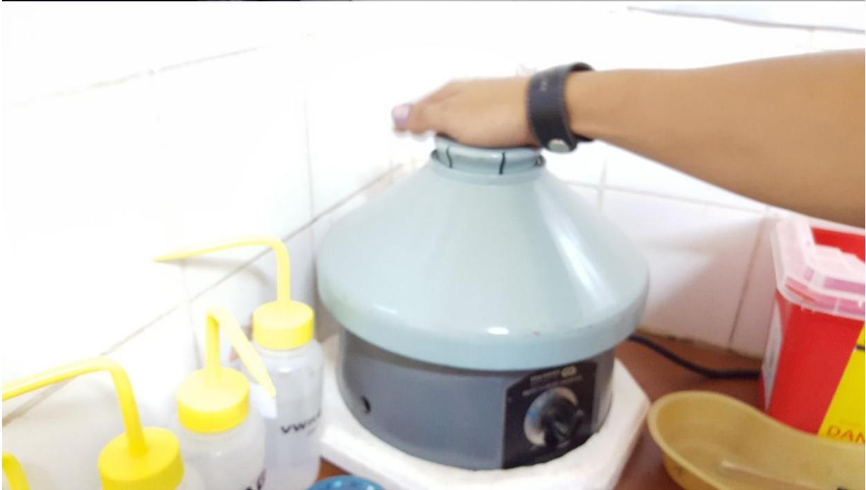
Preparación por centrifugación de los tubos con solución al fresco para la concentración de la muestra recogida y así facilitar la lectura de levaduras por microscopía. También se ilustra la realización de la prueba de KOH al fresco.
