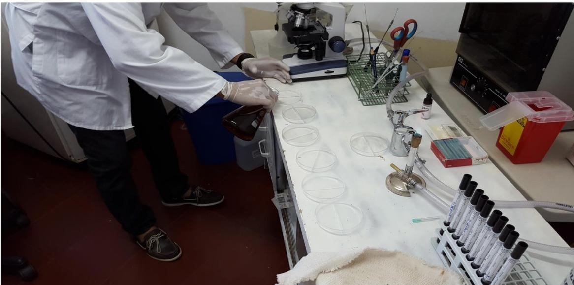
Se esteriliza en autoclave a 121°C por 15 minutos y con las medidas de seguridad y antisepsia se vierte en platos Petri.
