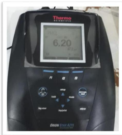
**Imagen 27: Instrumento para medir el parámetro conductividad**
