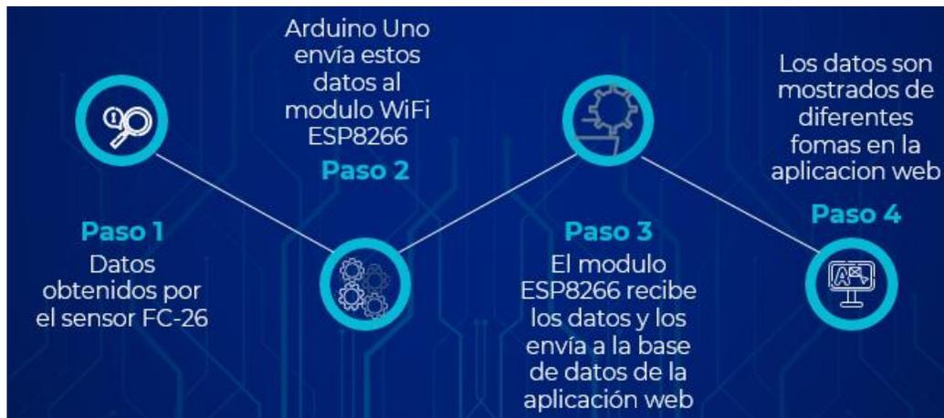
**Ilustración 18: Proceso de envío de datos del sistema automatizado a la aplicación web de monitoreo.**
