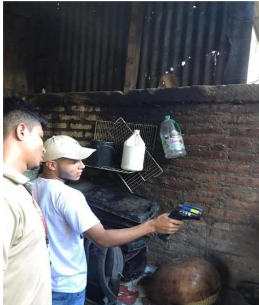
*Toma de temperatura en cámara de combustión y cámara de cocción de un horno mejorado.*
