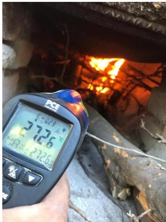
Toma de temperatura con termómetro laser en cámara de combustión del horno mejorado .
