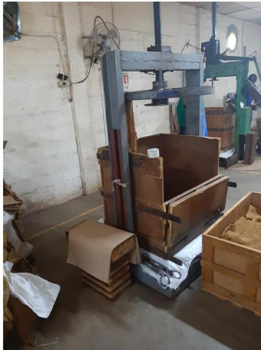
*Imagen 20 Máquina para prensar la paca del tabaco*
