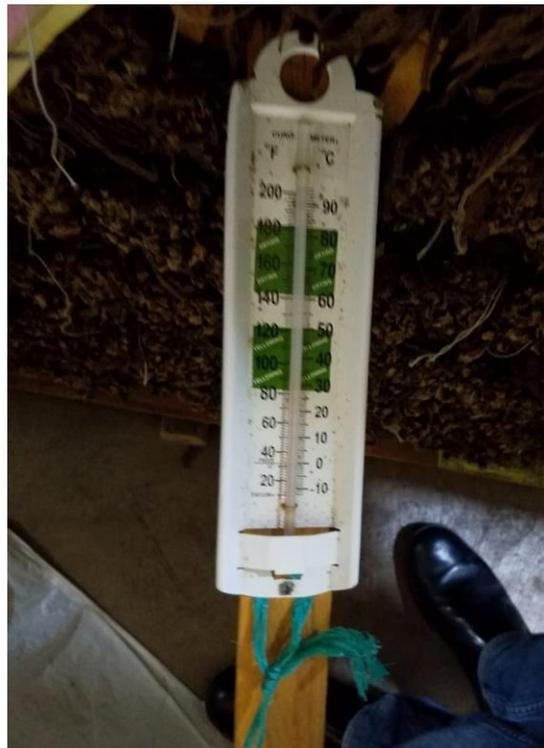
*Imagen 4 Termómetro para la medición de temperatura del pilón*
