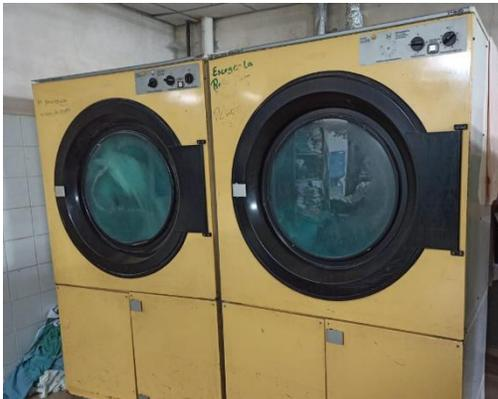
Ilustración 23 Secadora Industrial
