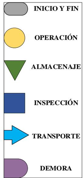
Figura 1 Diagrama esquemático de flujo
