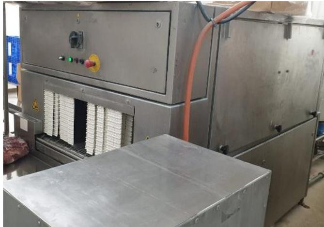
**Figura 6:** Túnel de encogido Térmico
