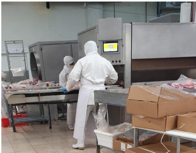
**Figura 4:** Máquina de empaque al vacío
