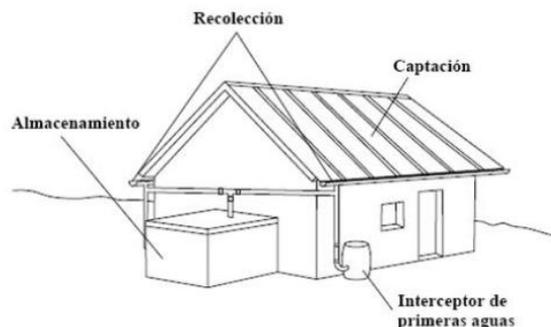
Figura 4. Sistema típico de captación de agua lluvia en techos (Global Water Partership Central América, 2016)
