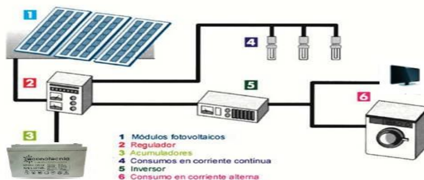
Figura No 6: sistema fotovoltaico independiente
