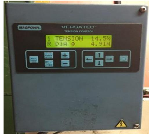
Figura 26 Unidad de control de tensión Fuente: Etimaquinarias S.A
