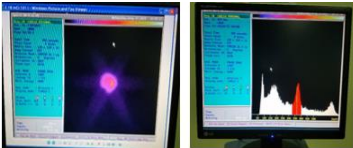
Ilustración 10: Verificación de geometría de impregnación y espectro emitido por la fuente.
