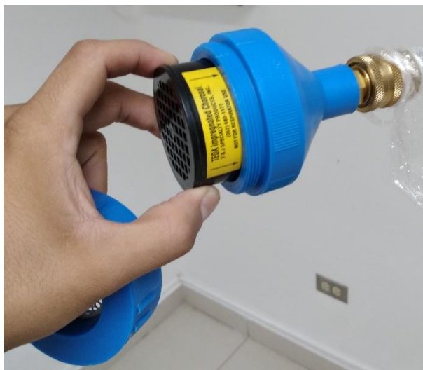
Ilustración 21: Colocación del filtro en el flujómetro.
