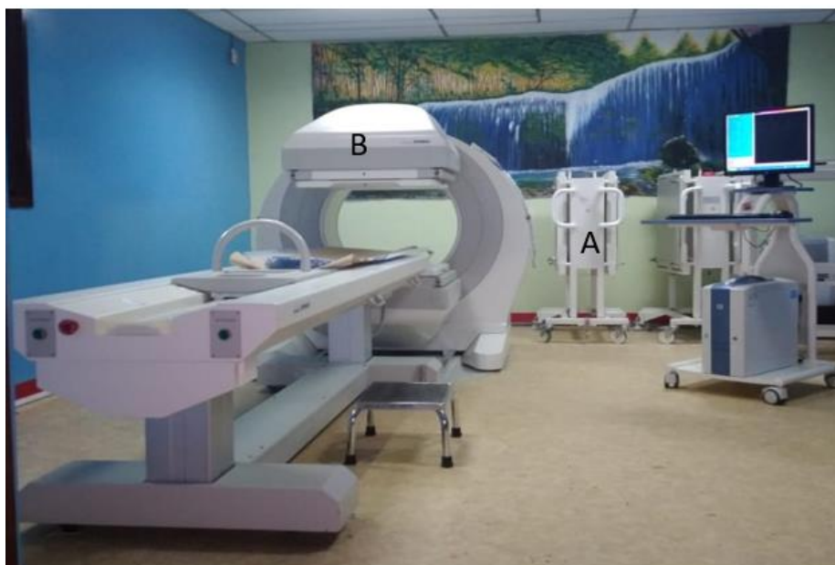
Ilustración 2: Equipo de Gamma cámara, Nucline SPIRIT, del servicio de medicina nuclear del CNR. (A): Carro para colimadores. (B): Cabezal detector. Fuente: Propia.
