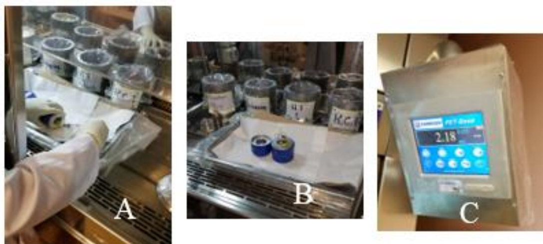
Ilustración 25: Impregnación del filtro de referencia con ^{131}\text{I} para la calibración del sistema de detección CAPTUS 3000.
