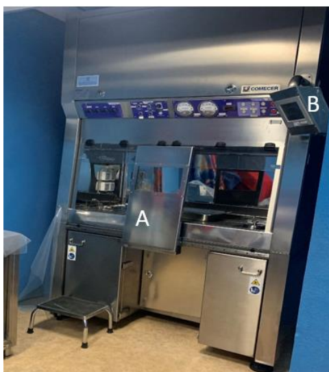
Ilustración 1: Cámara Caliente del servicio de medicina nuclear del CNR. A: Castillos de plomo. B: Activímetro. Fuente: Propia
