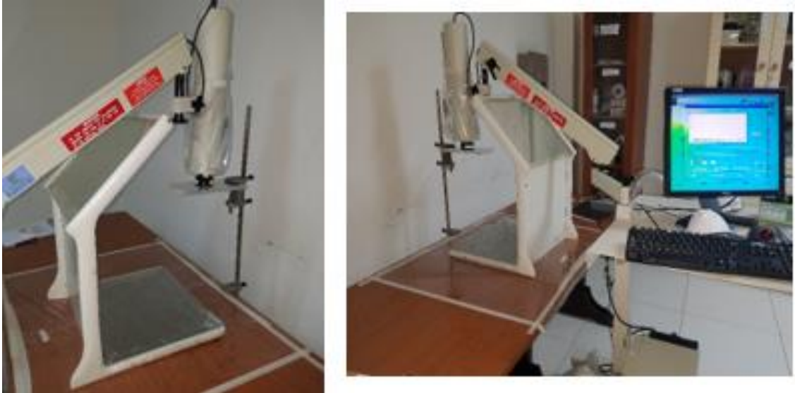
Ilustración 11: Geometría de medición con una distancia fuente detector de 18 cm.
