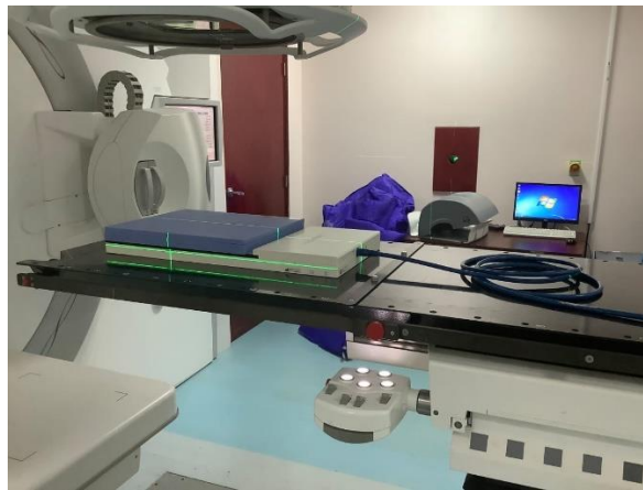
Ilustración 17. Fantoma MapCHECK 2 correctamente posicionado. (fuente propia)
