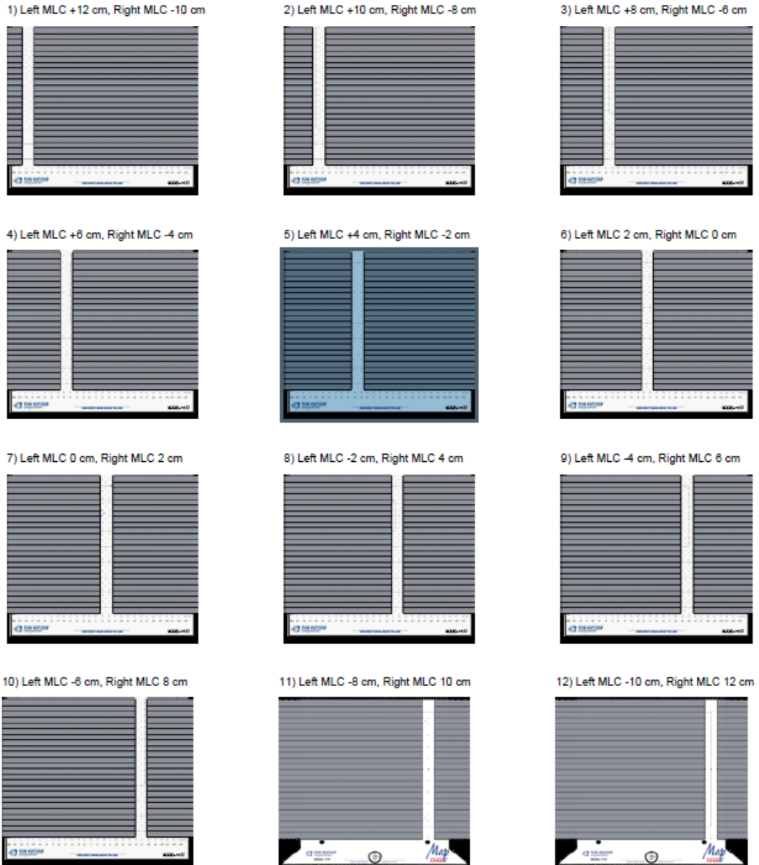
Ilustración 35. Plan Picket Fence para un tamaño de campo de 25x25 cm 2 .
