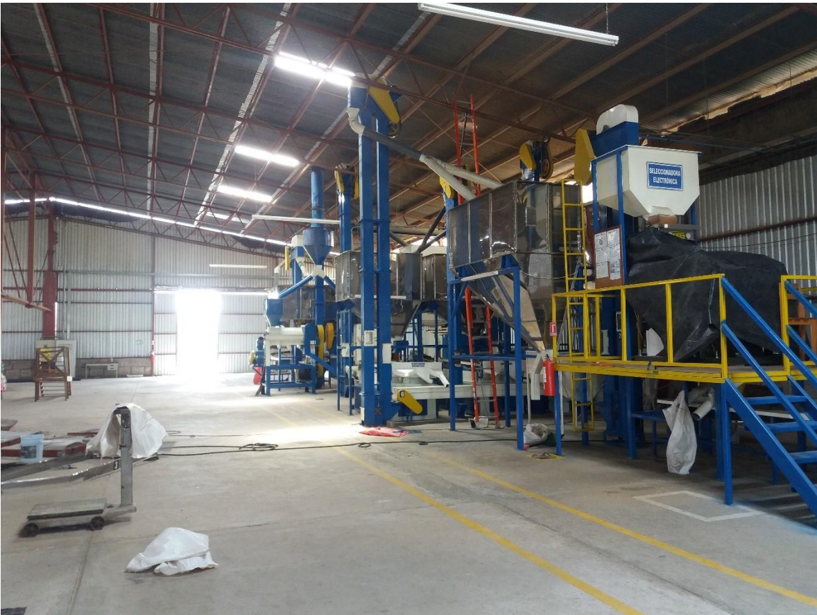
Ilustración 43. Máquinas de producción de café oro, pre limpiadora al fondo, y escogedora electrónica a la derecha. Fuente: Gira de campo.
