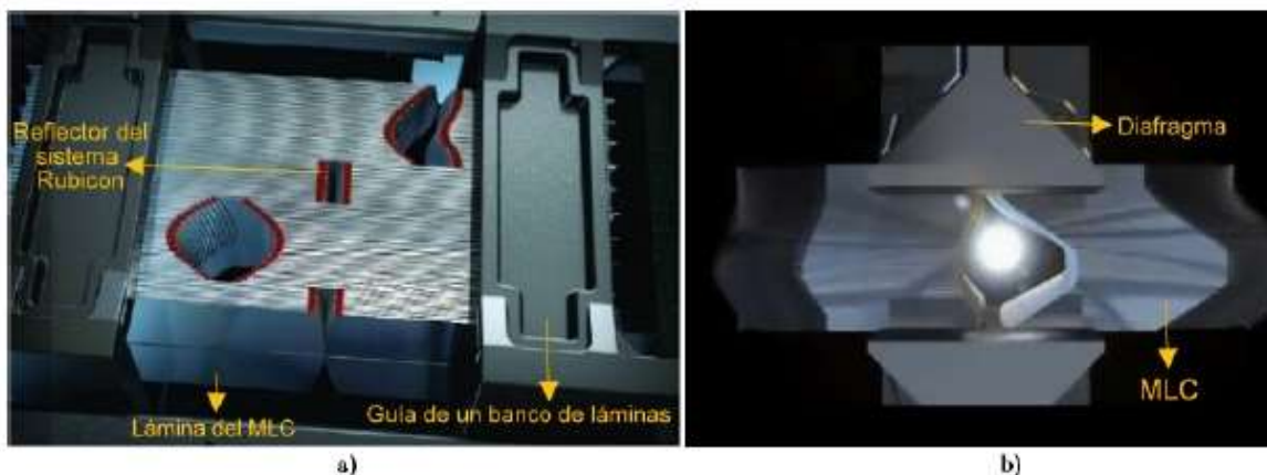
Ilustración 14: a) Colimador multiláminas Agility, b) Diafragma que determina el tamaño de campo en la dirección y (Agility multileaf collimator, 2017).
