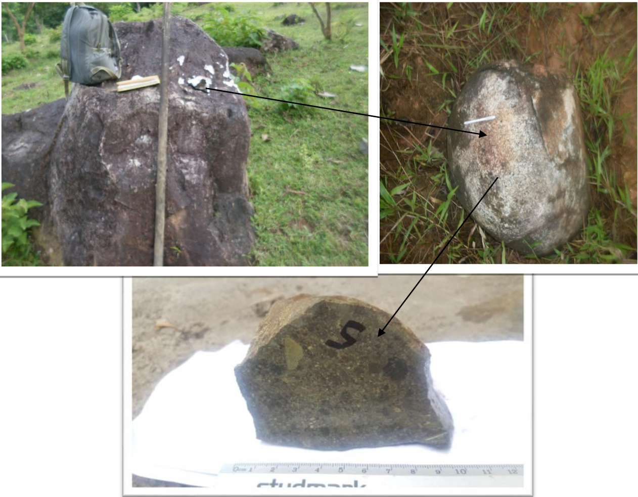
Foto 1. Afloramiento de flujo brecha, líticos sub-angulosos y sub redondeados moderadamente posee alteración clorítica, ubicada cercana al río Bambana. Fuente: Elaboración propia. Coordenadas: E 747050, N 1540831, Elev. 435 msnm.
