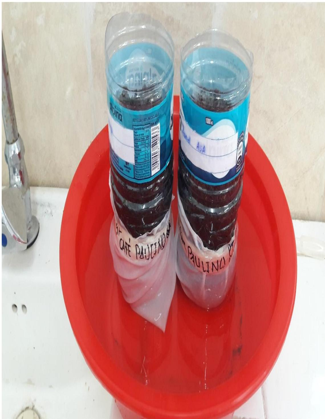
Fotografía 7. Infiltración del suelo en un periodo de 72 horas
