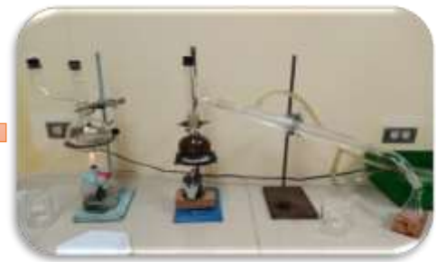
Organización del equipo de destilación
