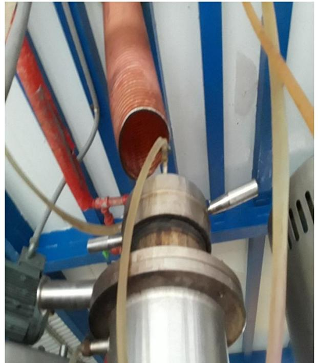
**Figura 54.** Conexión entre marmitas y molino
