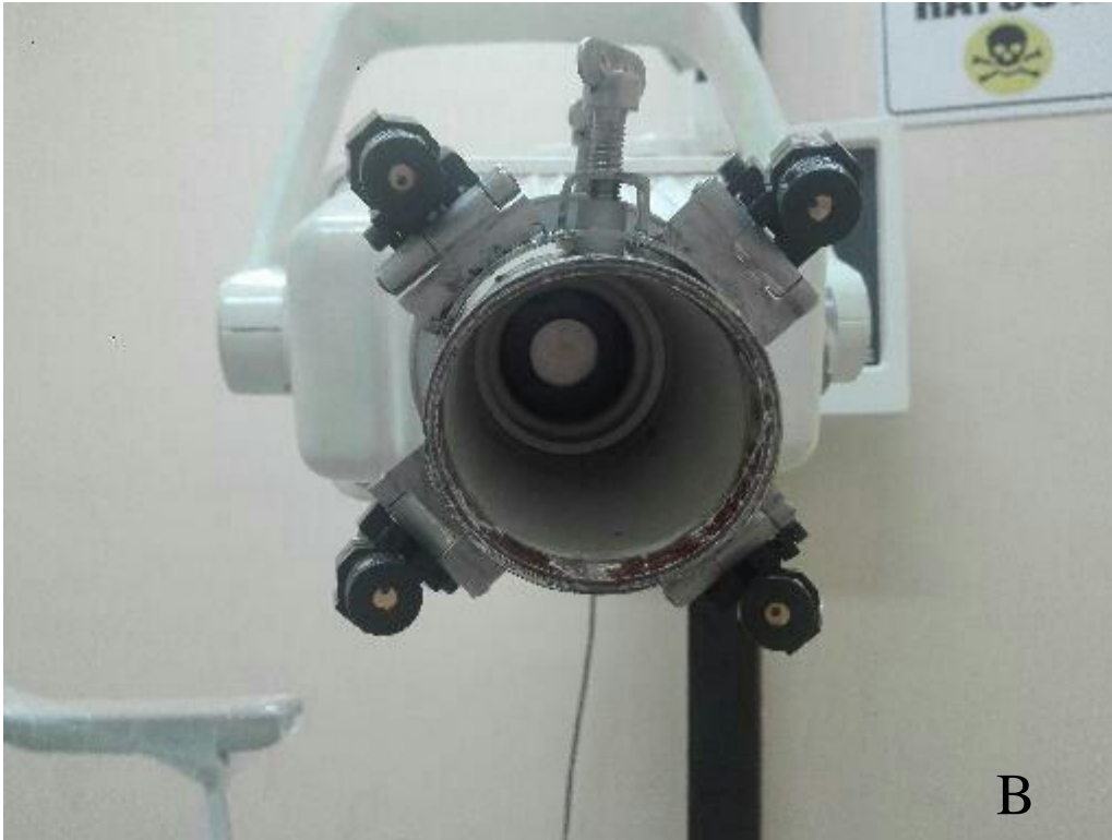
Figura No.6. Aditamento adaptado al cono de rayos X. A. Vista lateral. B. Vista Frontal
