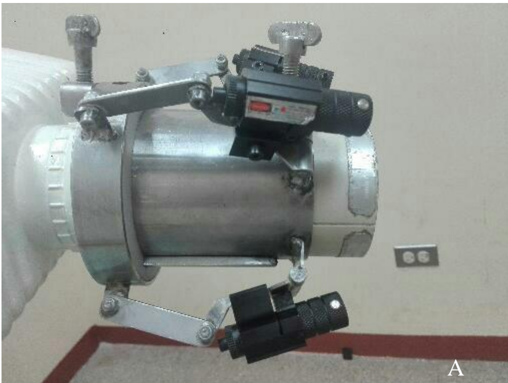
Imagen No. 5. Aditamento previo a ser colocado al cono de rayos X.
