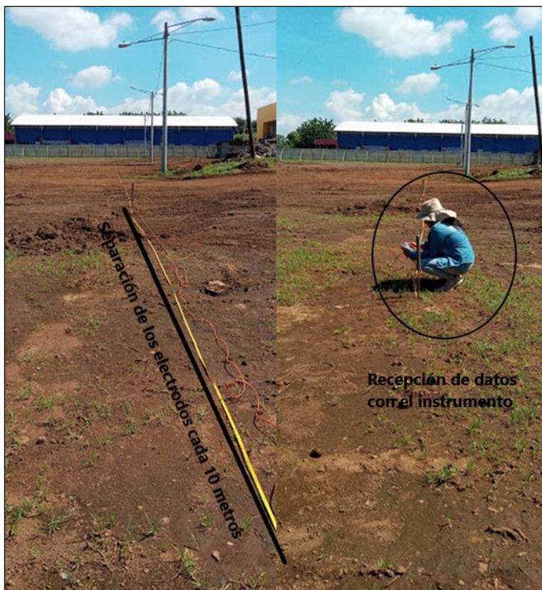
*Fotografía 1. Medición del campo electromagnético con el equipo de prospección PQWT-TC en campo.*
