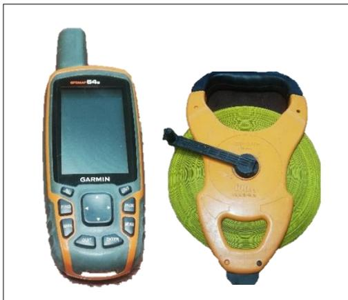
*Figura 14. GPS y Cinta de medición de 100 m.*
