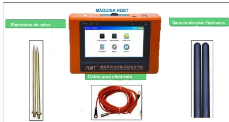
*Figura 15. Instrumento de prospección geofísica de la serie PQWT-TC.*
