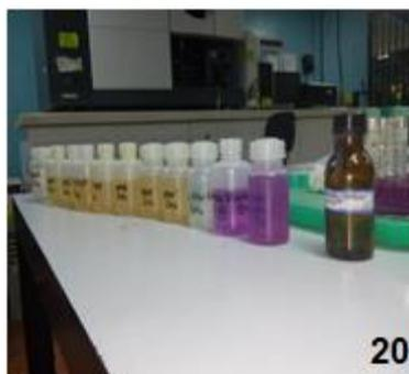
En las figuras 17 y 18 se muestra la digestión alcalina en baño maría a de 90 °C por una hora para la determinar del Cromo hexavalente. En las figuras 19 y 20 se observa las muestras listas para ser leída en espectrofotómetro ultravioleta.
