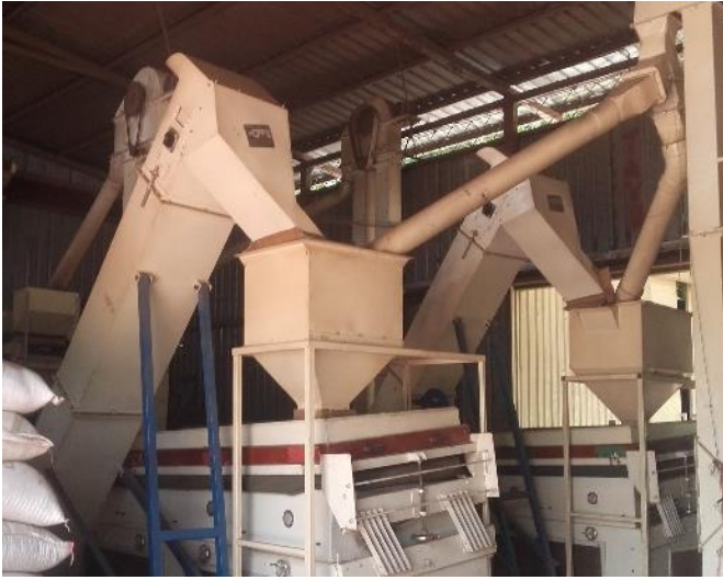
Imagen 8: Densimétrica máquina encargada de la clasificación de calidades del frijol.
