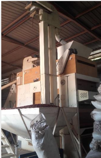
Imagen 7: Maquinaria encargada de la primera fase del proceso: tolva de recepción, elevador, maquina Pre-limpiadora.
