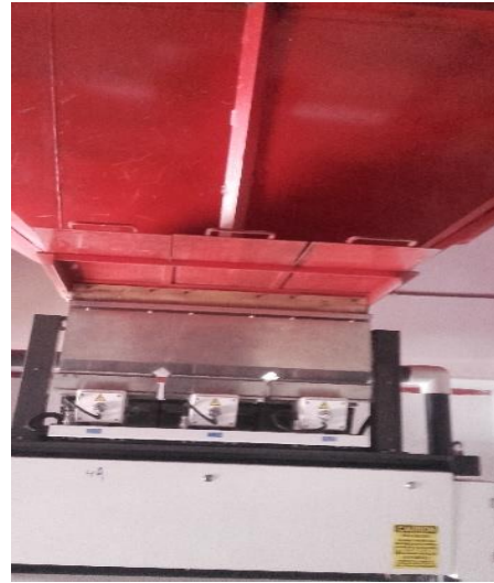
Imagen 13: Tolva y pesa para realización de empaquetado de sacos de 50lbs.
