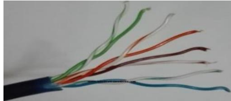
Figura 3. Par trenzado sin blindaje (UTP) categoría 6.
