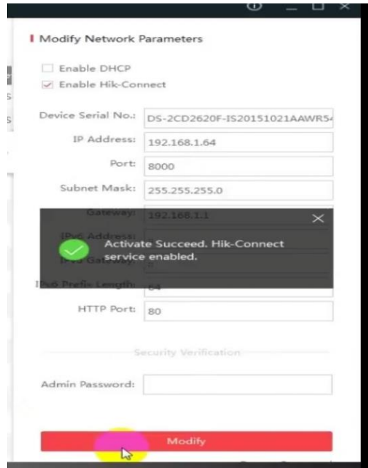
Figura 16. Configuración de ip de las cámaras. Fuente: Propia
