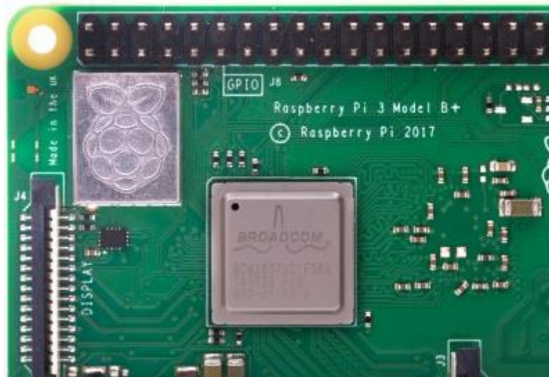
Figura 7. Chip “combo” Cypress CYW43455 que proporciona LAN inalámbrico de doble banda y Bluetooth encapsulado bajo el logo de raspberry
