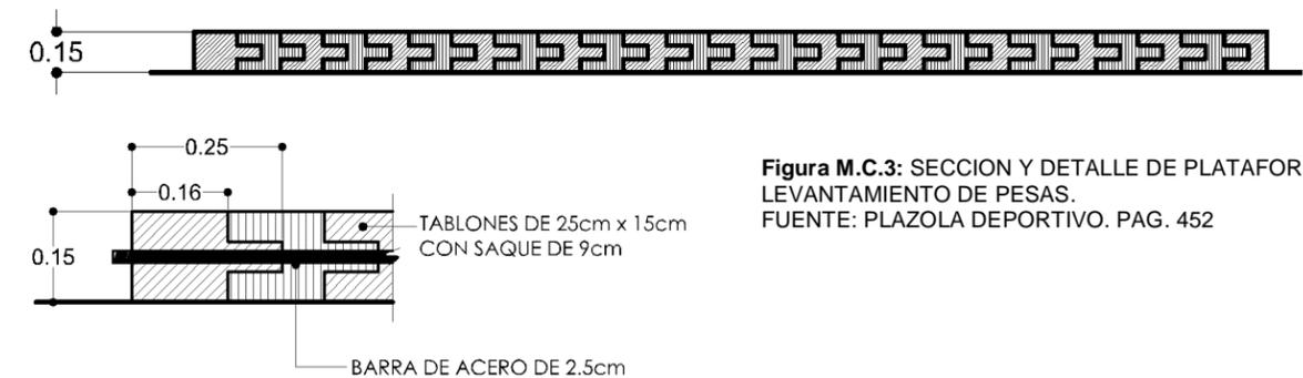
**Figura M.C.3:** SECCION Y DETALLE DE PLATAFORMA LEVANTAMIENTO DE PESAS. FUENTE: PLAZOLA DEPORTIVO. PAG. 452
