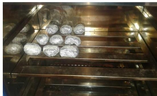
**Foto 5.** Muestras de peso fresco de suelo dentro del horno
