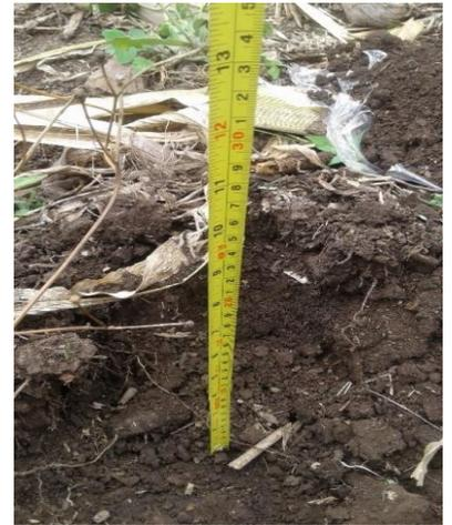
**Foto 3.** Muestreo de materia orgánica a 10cm utilizando el método de cuadrante en los diferentes sistemas de agricultura (Conservación y Convencional)
