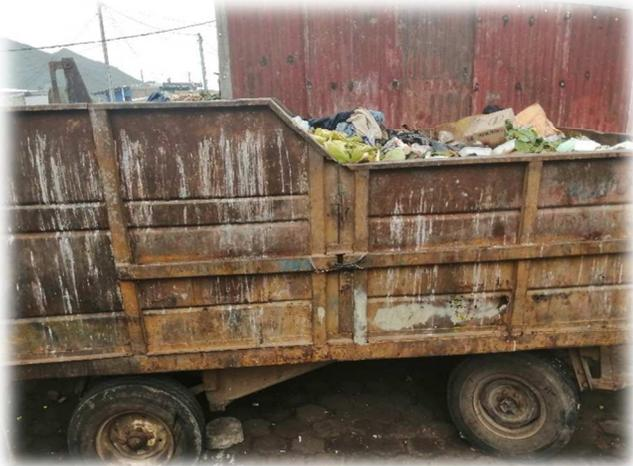
**Foto N° 6. Tráiler receptor para traslado de residuos sólidos del mercado hacia el basurero**
