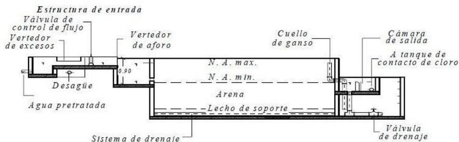
Corte longitudinal de un filtro lento en arena.
