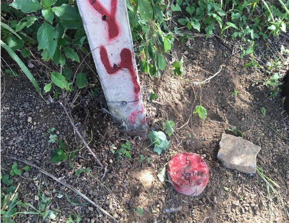
*Ilustración 10 Vertice 4 de la poligonal (2019). Fuente propia*
