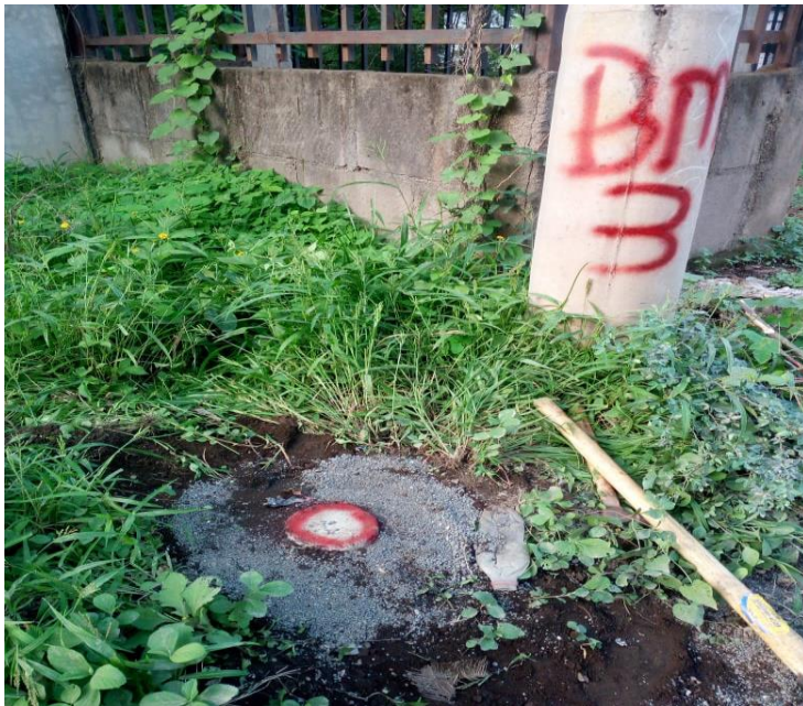
Referencia BM-3 X: 571629.087 Y: 1339375.94, Z: 205.409. Estación...
