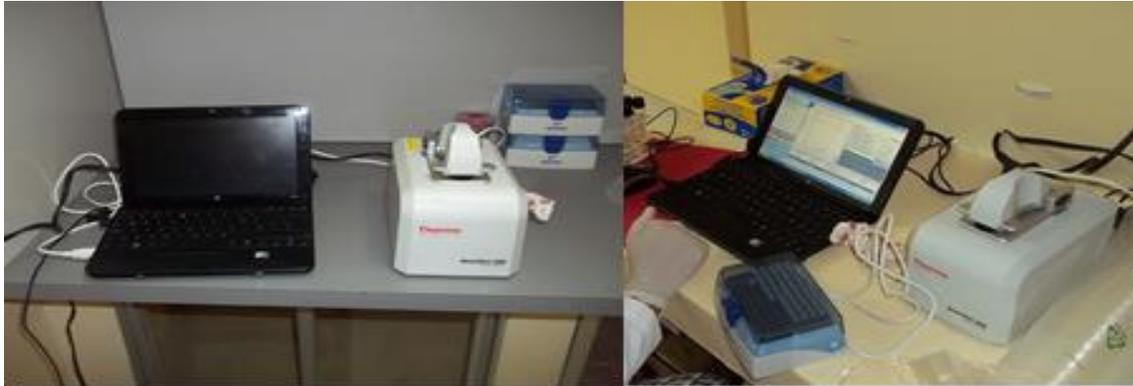
Imagen 8. Espectrofotómetro Nanodrop2000 para la medición de proteínas.
