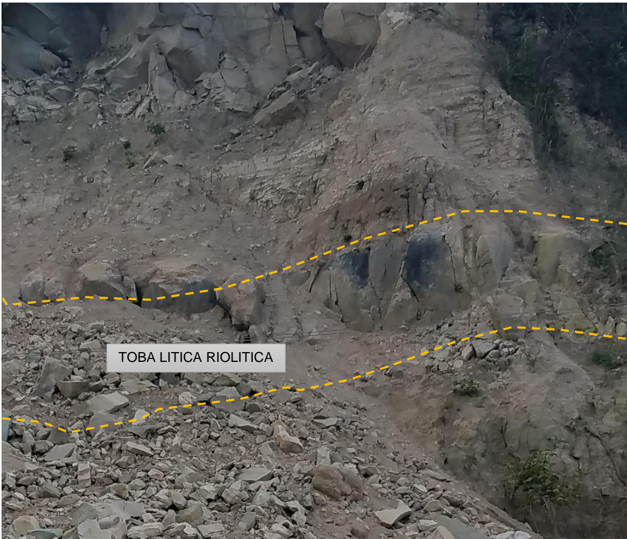
Foto 6. Toba lítica riolítica con clastos gruesos y un grado de alteración por oxidación avanzado coordenadas UTM-WGS84: N1335014 E707068. Fuente: elaboración propia.
