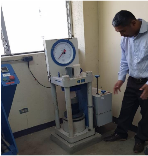
Anexo 4. A) Se tomaron las muestras y cada una de ellas fue sometida a presión usando Máquina de compresión, la cual nos permitió obtener el grado de fractura de cada una de ellas y así poder calcular sus propiedades geomecánicas. B) Muestra fracturada
