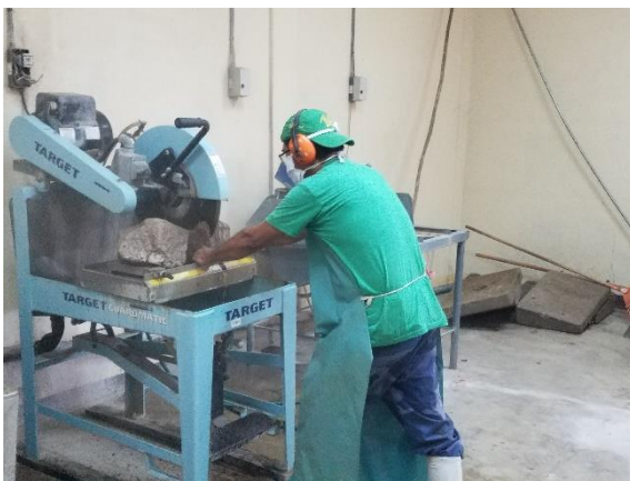
Anexo 2. A) Se observan el proceso para el corte de las muestras en un cubo/rectángulo casi perfecto para calcular su volumen. B) Las muestras tobaceas de composición riolítica, además de toba lítica y aglomerado.
