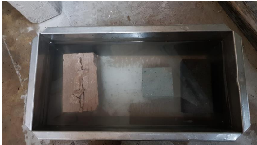
Anexo 4. Sumersión en agua los bloques de las muestras ya cortadas y nuevamente pesadas
