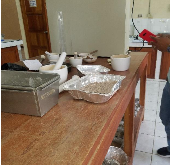
Anexo 1. A) se observa parte de las muestras del estrato de suelo usadas en la clasificación granulométrica para determinar el tipo de material. B) Utilización de tamices de diferentes diámetros de la muestra para clasificarla.
