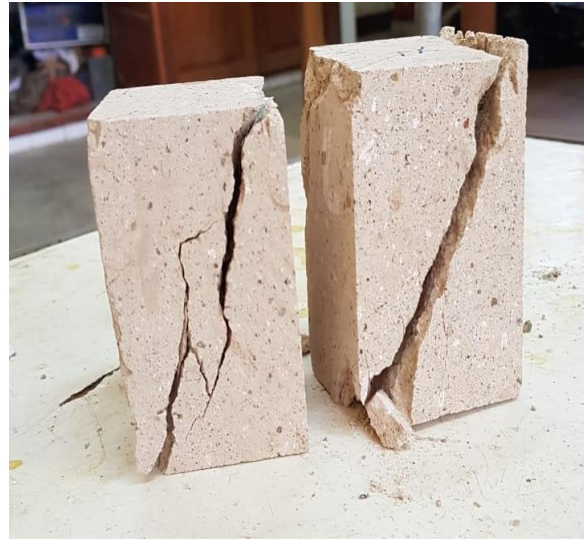
Anexo 4. A) Se tomaron las muestras y cada una de ellas fue sometida a presión usando Máquina de compresión, la cual nos permitió obtener el grado de fractura de cada una de ellas y así poder calcular sus propiedades geomecánicas. B) Muestra fracturada
