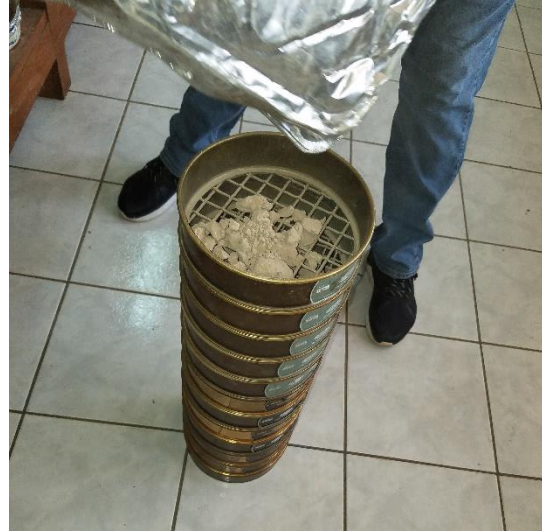
Anexo 1. A) se observa parte de las muestras del estrato de suelo usadas en la clasificación granulométrica para determinar el tipo de material. B) Utilización de tamices de diferentes diámetros de la muestra para clasificarla.
