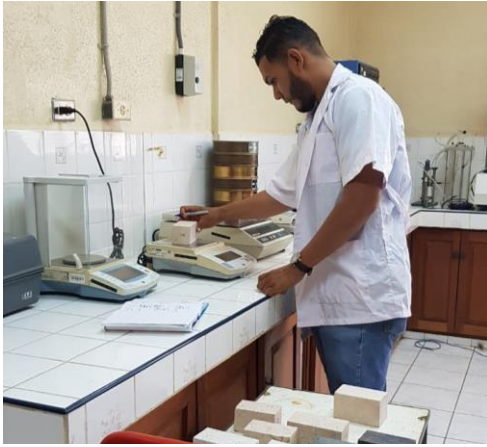
Anexo 3. A) Pesar las muestras individualmente obteniendo su peso exacto usando una pesa especializada. B) muestras cortadas en cubos y rectángulos después de su pesaje.
