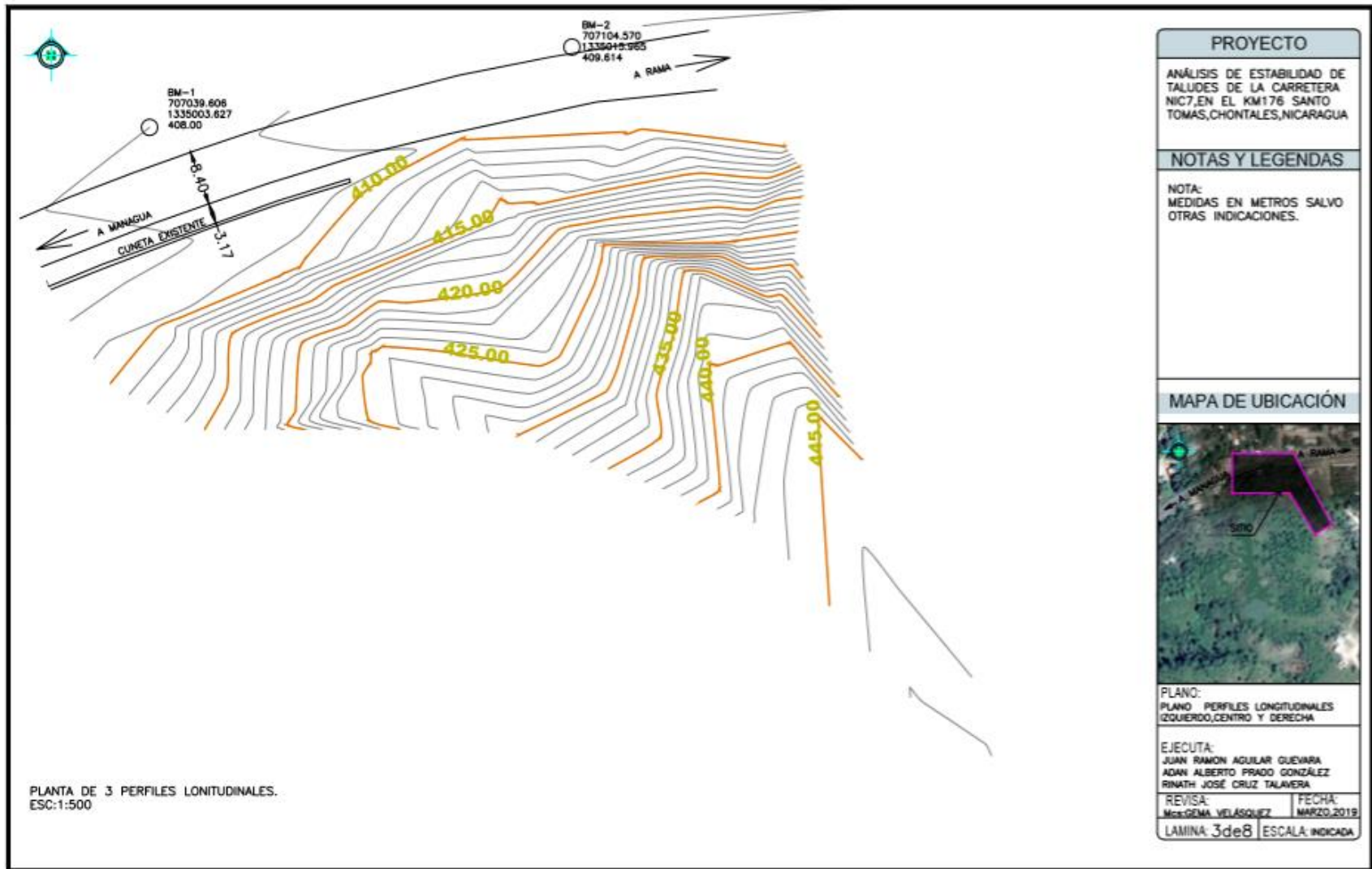
Figura 18. Curvas de nivel del talud. Fuente: elaboración propia.
