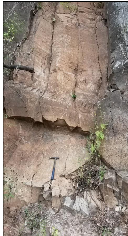
Foto 22: Se observa la forma columnar que tiene la unidad, así como también el grado de meteorización (642711 E – 1397331 N)
