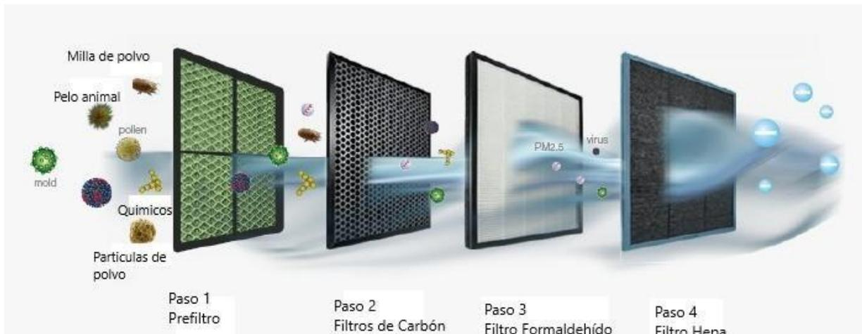
*Ilustración 12 Ejemplo de filtro de aire, compuesto por un filtro HEPA (Midea, s.f.)*
