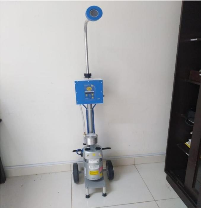
*Ilustración 14 Aspiradora de volumen ajustable modelo DF-14ME*
