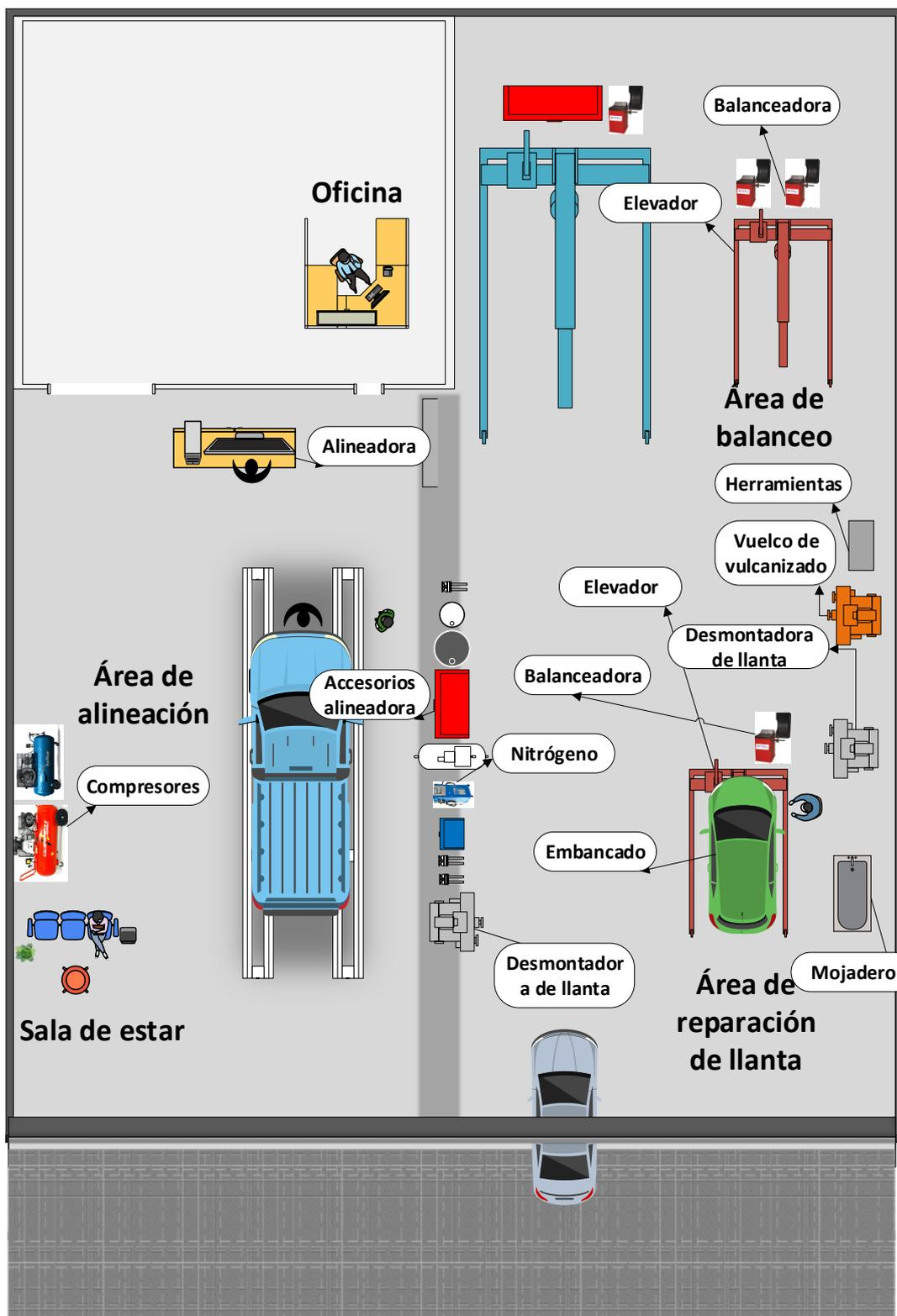
Figura 31: Diseño de planta propuesto
