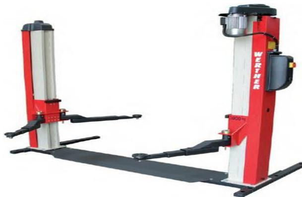
*Figura 10: Máquina elevador 2 columnas.*
