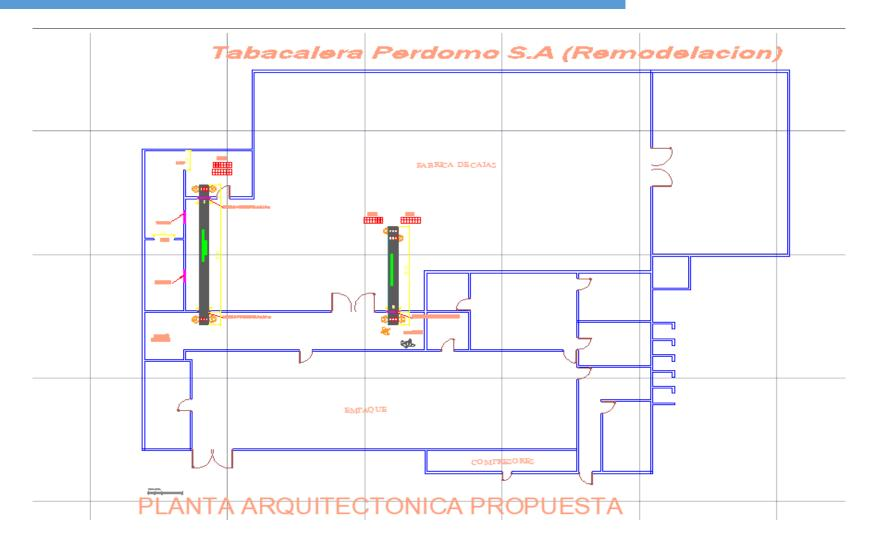
**Figura 26:** Ubicación propuesta de las bandas transportadoras dentro del plano de distribución del área de fabricación de cajas de Tabacalera Perdomo S.A
