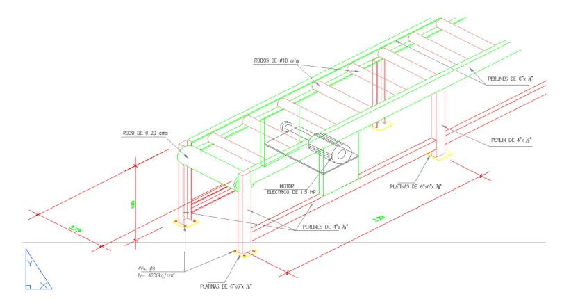
**Figura 23:** Diseño de banda transportadora propuesta para ubicarse entre corte y armado, dentro del área de fabricación de cajas de Tabacalera Perdomo S.A.
