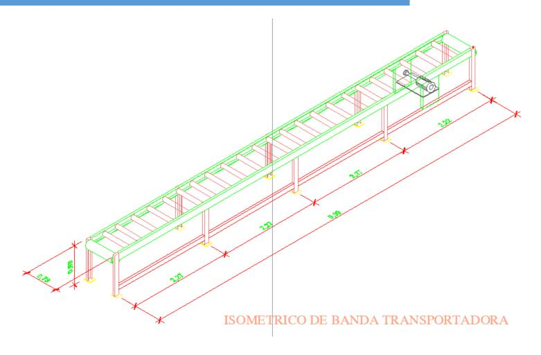
**Figura 24:** Diseño de banda transportadora propuesta para ubicarse entre banda y lijado manual, dentro del área de fabricación de cajas de Tabacalera Perdomo S.A.
