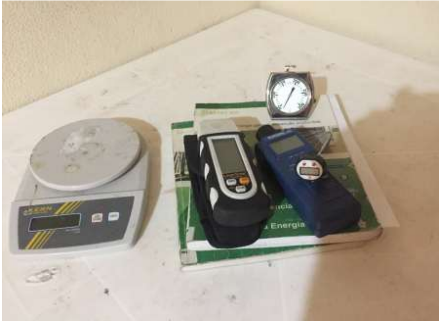
Figura 26. Equipos de Mediciones, balanza, medidor de humedad, termómetros, medidor de monóxido
