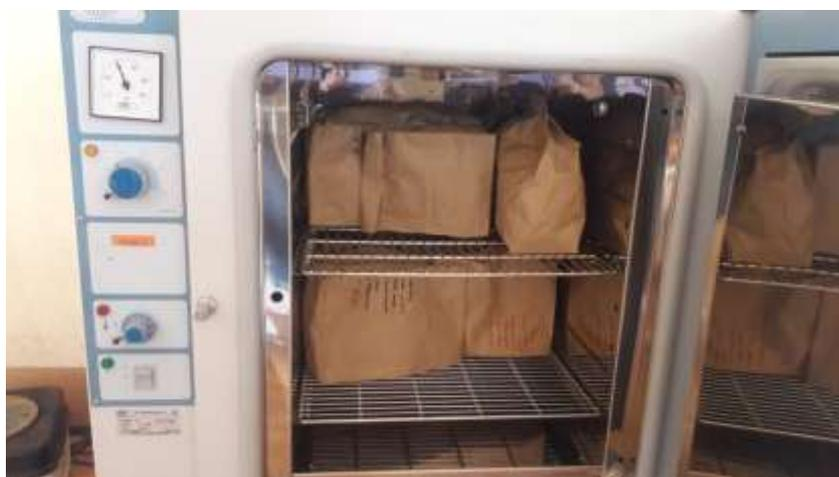
**Foto 4. Secado de muestras en el horno del laboratorio Estación Experimental**
